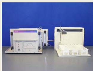
Analizador de mercurio por fluorescencia atómica
